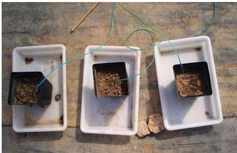
**Figura 5.** Las tres macetas con las sondas Watermark para medirles el potencial hídrico
