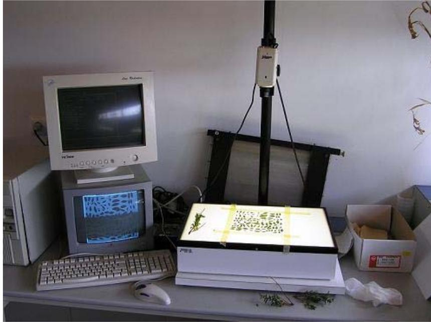
**Figura 10.** Medidor de área foliar DELTA-T
