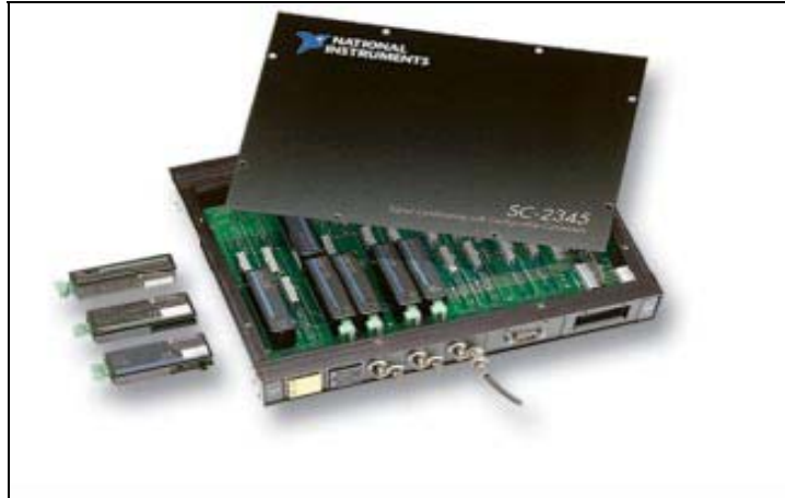
Figura 7.- Bloque de acondicionamiento de señal y módulos de acondicionamiento
