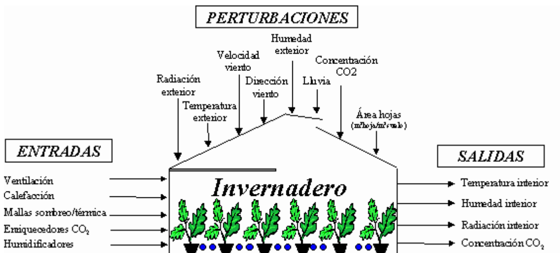
Figura 1.- Ciclo de entradas, salidas y perturbaciones en un invernadero
