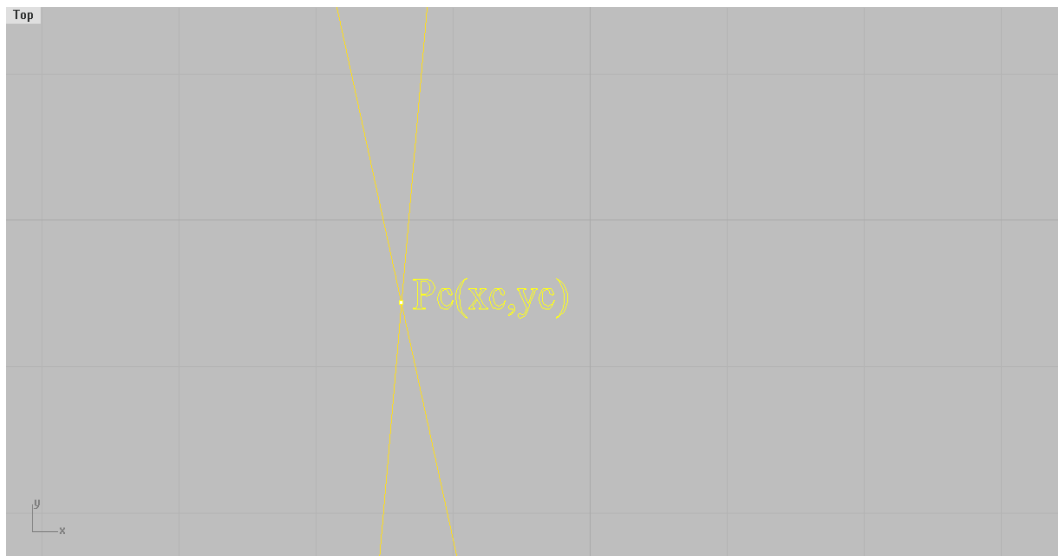
Figura 11.6.- Centro de la circunferencia P_c(x_c, y_c) = P_c(\xi_c, \psi_c) que pasa por los tres puntos resultado de la intersección de ambas mediatrices
