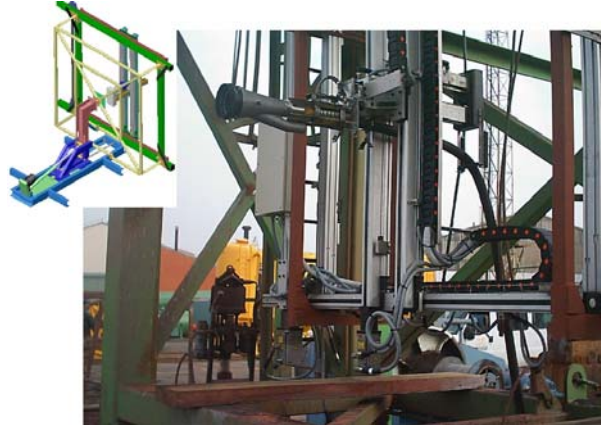
Figura 17. Robot cartesiano desarrollado en el marco del proyecto EFTCoR.
