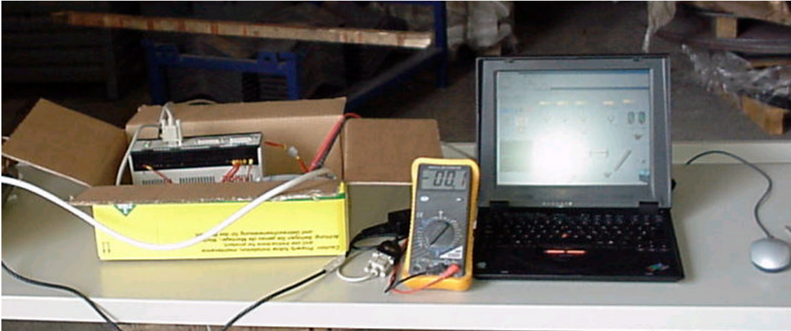
Figura 7.- Disposición del PC y el controlador para la realización de la calibración (el controlador se coloca sobre un envase de cartón para evitar posibles contactos con la mesa metálica).
