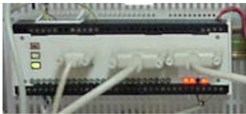
Figura 2- Aspecto físico del controlador industrial InfoDina.
