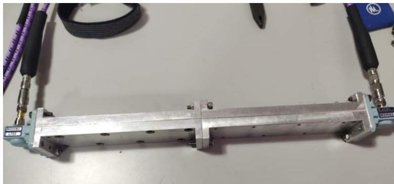
Figura 78: Proceso de calibración, Through
