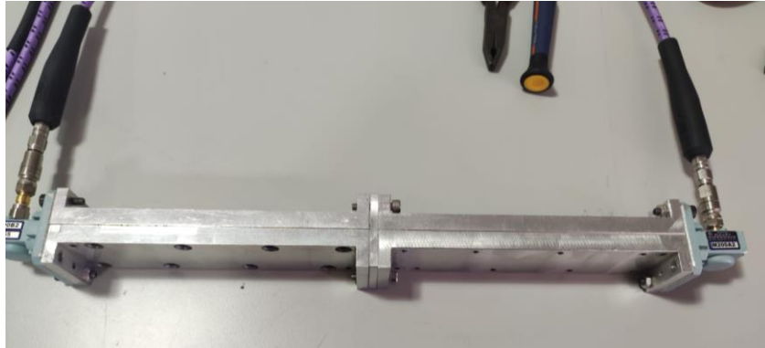
Figura 79: Proceso de calibración, Reflect. Entre las dos guías se coloca una placa metálica que implementa un cortocircuito, de manera que toda la potencia incidente se refleja
