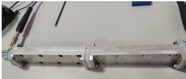
Figura 80: Proceso de calibración, Line. En este caso las dos guías de los puertos se conectan con una línea de cierta longitud conocida
