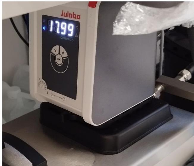
*Figura 42. Refrigeración establecida a la temperatura señalada 17.99°C*
