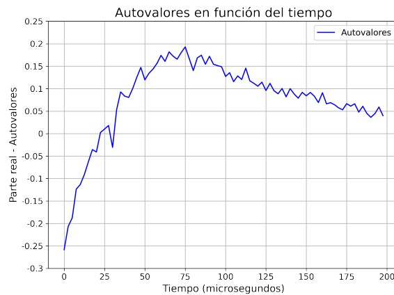
Figura 23: Representación que despliega la evolución de la parte real de los autovalores durante el proceso de “Quantum State Tomography”. En el eje vertical (Y), se mapea la magnitud de la parte real de los autovalores, revelando las características fundamentales del estado cuántico en estudio. El eje horizontal (X) cronometra la secuencia temporal de la evolución, permitiendo una interpretación clara de cómo fluctúan estos autovalores a lo largo del tiempo.
