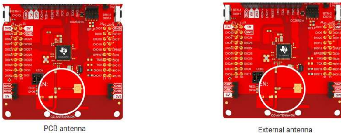
Figura 4.2: Modificación del necesaria LAUNCHXL-CC2640R2 para conectar el BOOSTXL-AOA
