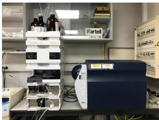
**Figura 4. 6.** Cromatógrafo líquido de alta resolución (HPLC-DAD-ESI-MS<sup>n</sup>) acoplado a trampa de iones, utilizado para la identificación de glucosinolatos y ácidos hiroxicinámicos.
