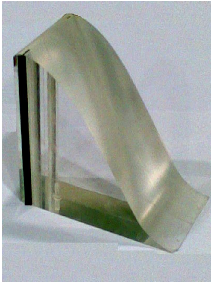
Figura 3.2. Aliviadero utilizado como estructura de control.
