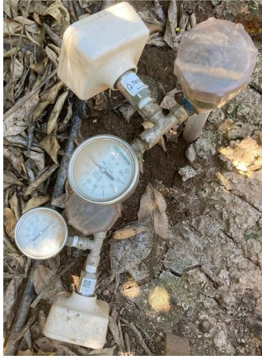
Figura 16. Tensiómetros Irrometer de 30 cm y 60 cm instalados en la parcela de estudio
