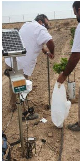
Figura 19. Técnico de Widhoc usando una barrena para realizar el agujero donde irán instalados los sensores a las profundidades correspondientes.
