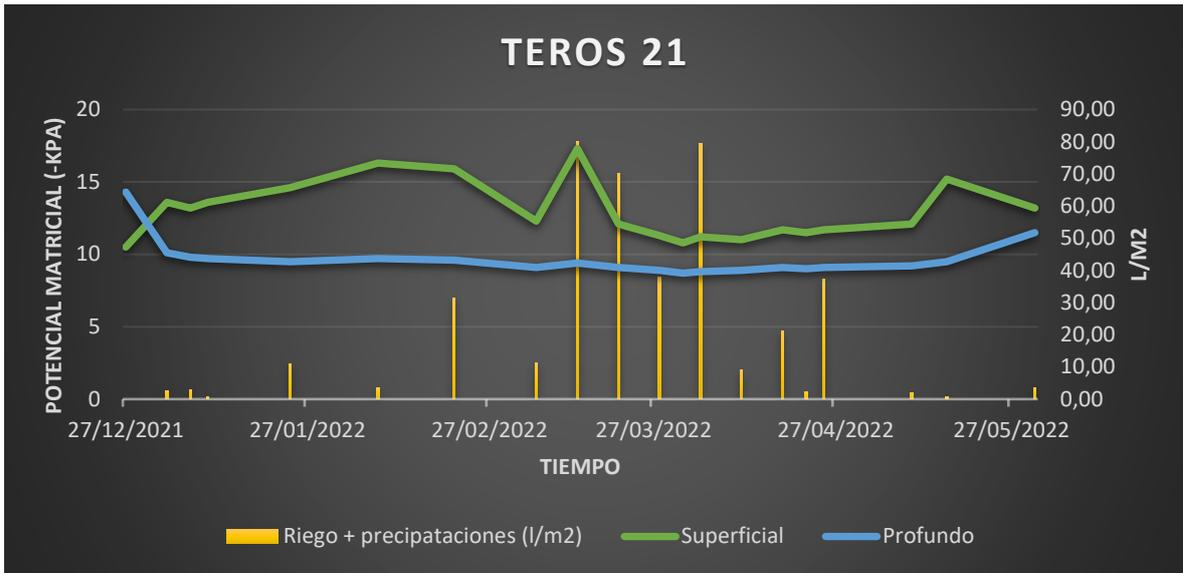
Figura 27. Representación de los datos recogidos por los sensores TEROS21
