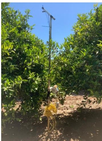
Figura 7. Primer equipo con la estaca con el datalogger, el panel solar y los cables sobrantes de los sensores instalados.
