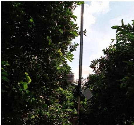
Figura 13. Segundo equipo con la estaca con el datalogger, el panel solar y los cables sobrantes de los sensores instalados.
