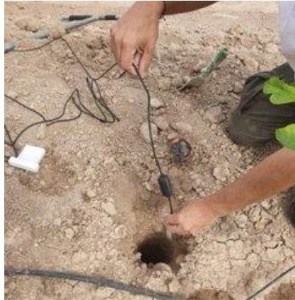
Figura 20. Técnico de Widhoc introduciendo los sensores en el agujero realizado con la barrena.
