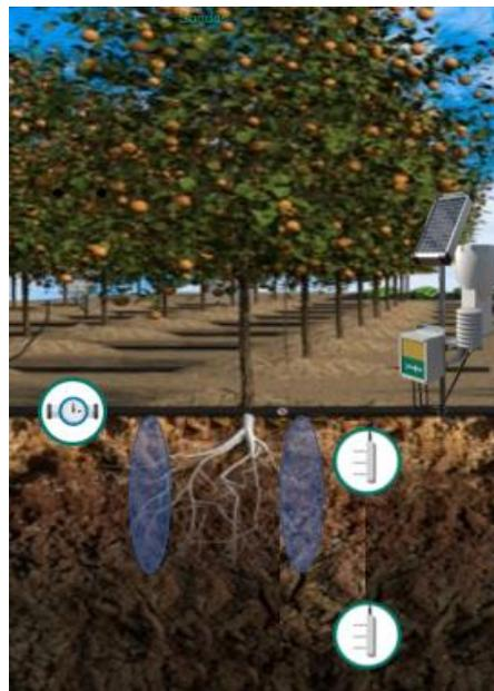
Figura 21. Imagen esquemática de como quedaría la distribución de los sensores y el equipo una vez finalizada la instalación.
