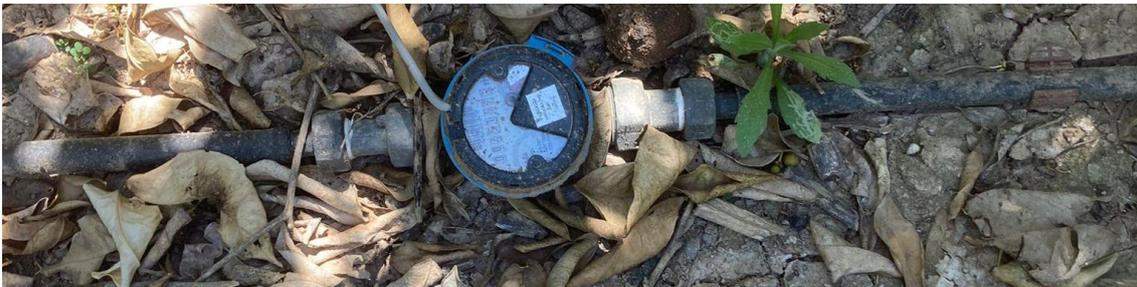
Figura 9. Caudalímetro instalado en la manga de riego de la parcela de estudio
