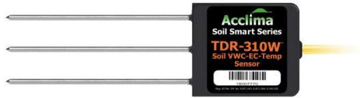
Figura 11. Sensor TDR-310 que mide humedad volumétrica del suelo. Fuente: ACCLIMA
