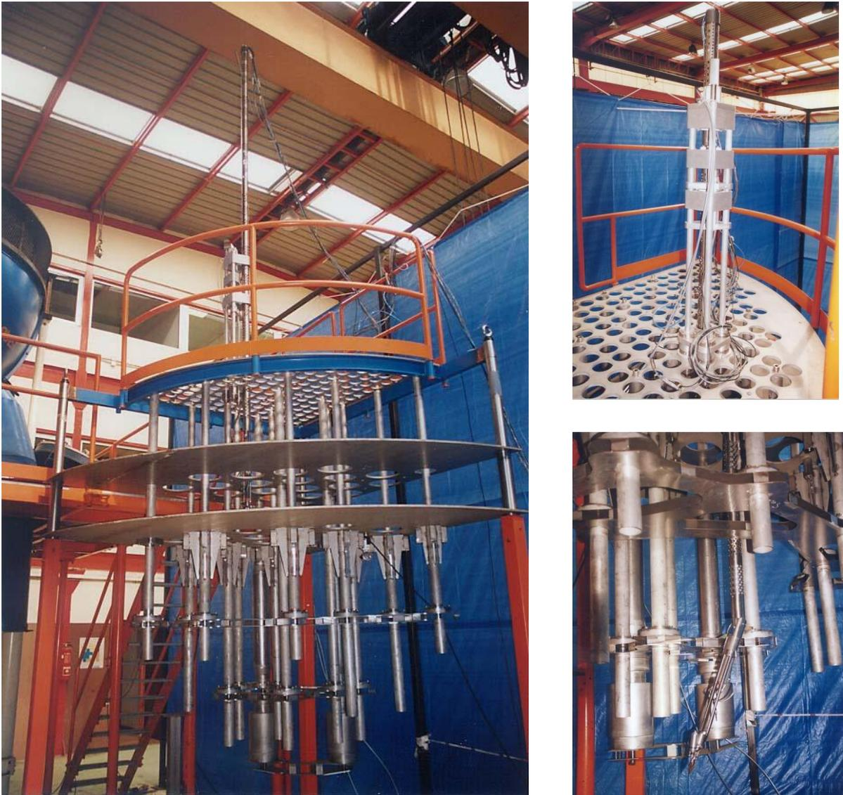
**Figura 7.3:** Sistema TRON. Pruebas en maqueta durante el desarrollo del sistema.
