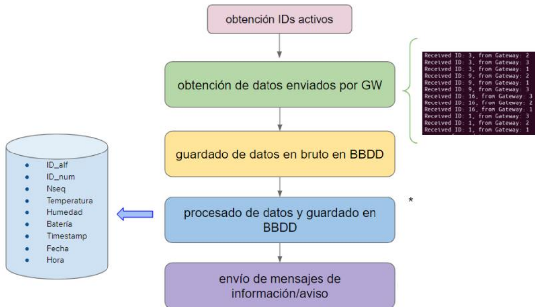
Figura 26. Diagrama de flujo recepción datos sensores IoT
