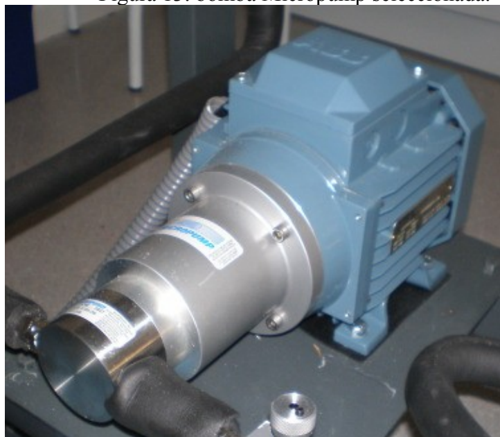
Figura 13: bomba Micropump seleccionada.
