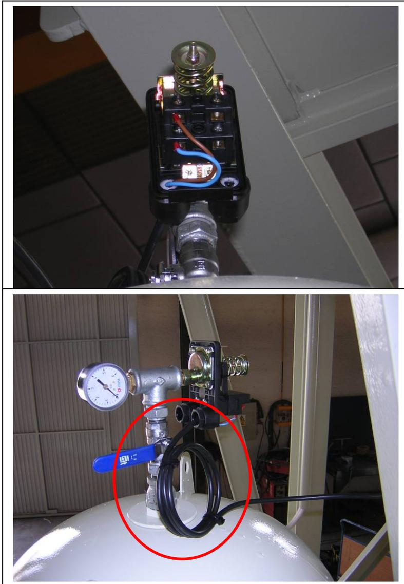
Para hacer la conexión del presostato se le pone primero unas punteras a los extremos de los cables para una mejor conexión. Se conecta un cable donde pone una “L” y el otro donde pone una “M”. Antes de hacer la conexión hay que dejar aproximadamente un metro de cable bien enrollado con doble vuelta como se ve en la fotografía por si hay que sustituir el presostato.
