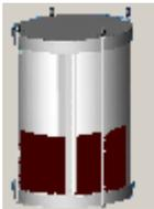
El aditivo por contador con vaso, es igual que el aditivo sin vaso. Solo que en vez de llenar directamente en el camión o en la báscula de agua, se llena un vaso de cristal o plástico transparente.
