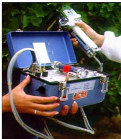
**Fotografía 3.5.** Porómetro de estado estacionario.
