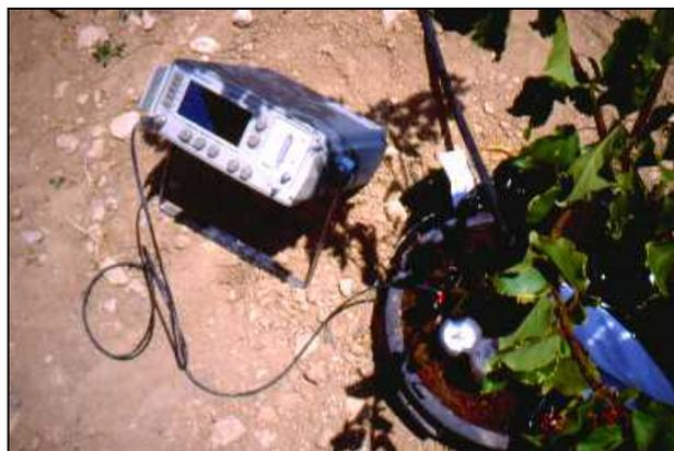
**Fotografía 3.1.** Equipo de medida de TDR y tensiómetro de vacío empleados en el ensayo en macetas.
