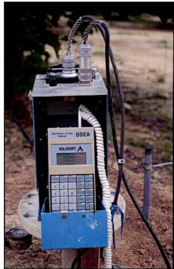
**Fotografía 3.2.** Sonda de neutrones empleada en el ensayo de albaricoqueros adultos.
