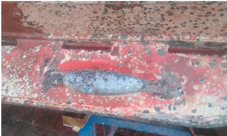
Figura 4. Ánodo de sacrificio en la quilla de balance.
