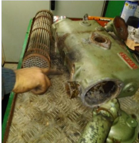
Figura 34. Apertura del intercambiador para la limpieza anual.
