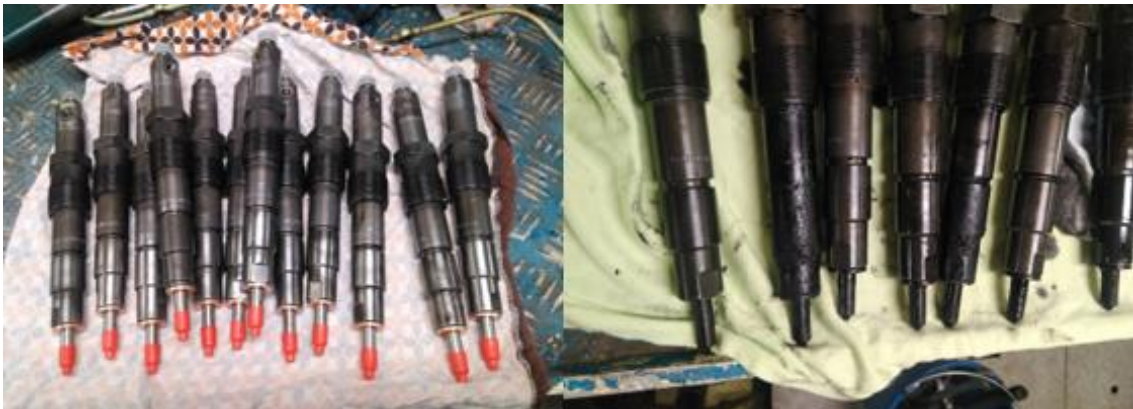
Figura 131. Sustitución inyectores por desgaste
