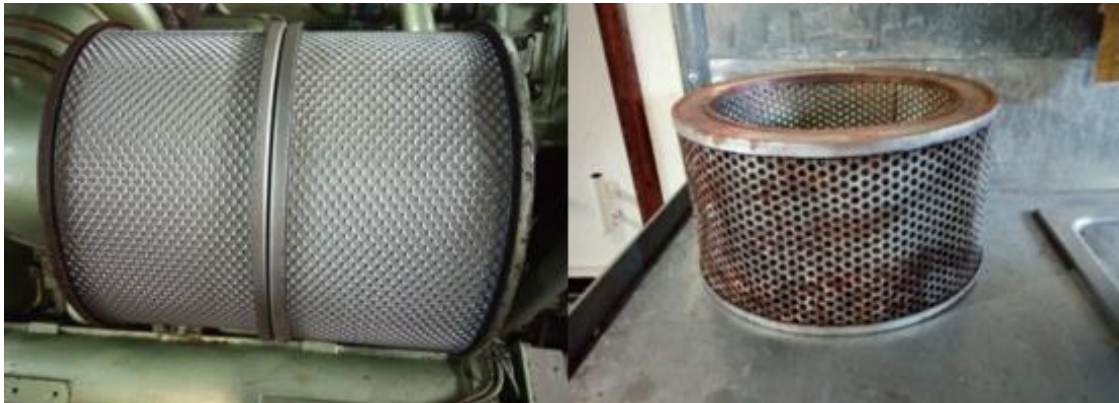
Figura 130. Cambio del filtro de admisión del motor principal
