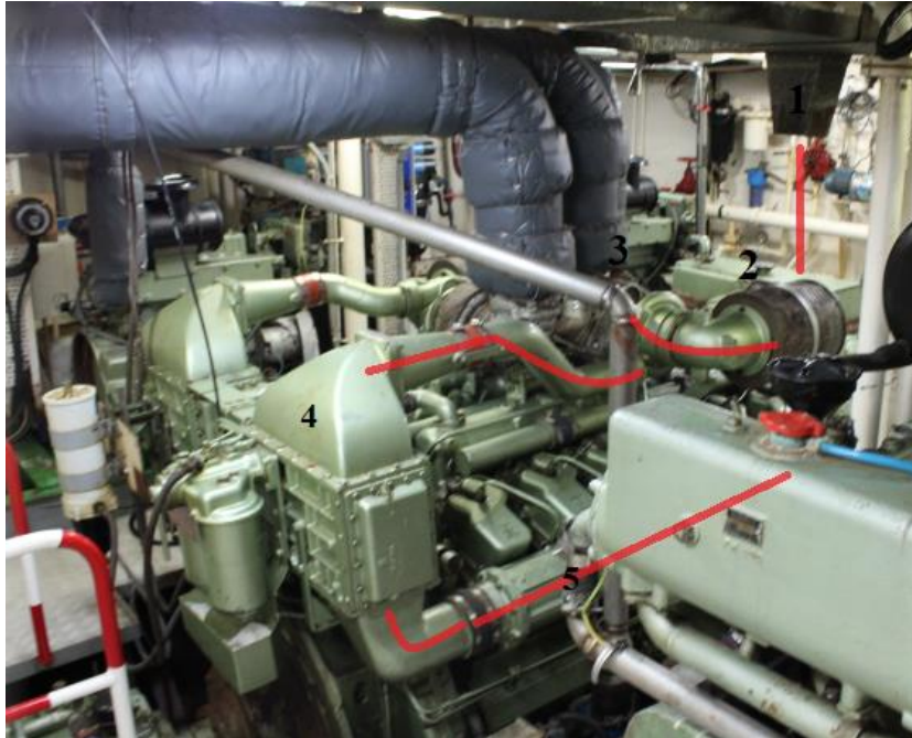
Figura 26. Recorrido del aire de admisión
