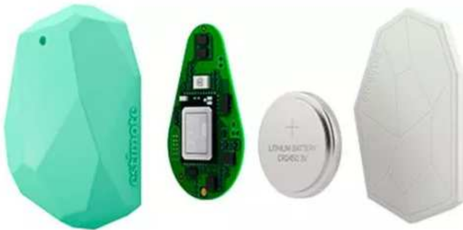
Ilustración 13. Explosionado de un iBeacon.
