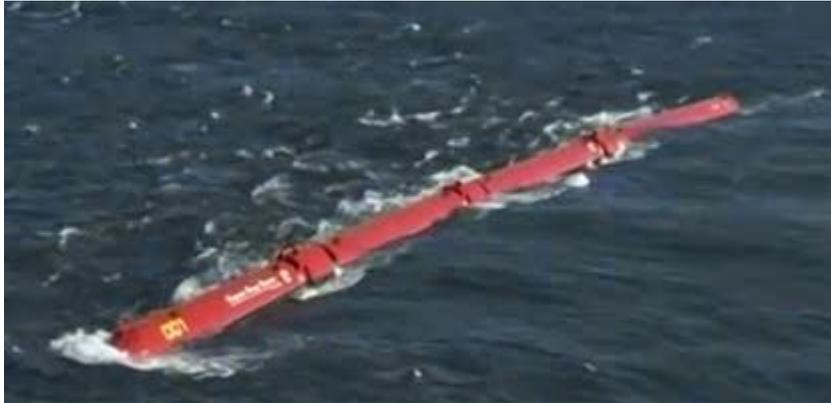
Figura 3.24: Vista del Pelamis, instalado en Portugal. Fuente: <http://ingenieroandreotti.blogspot.com>
