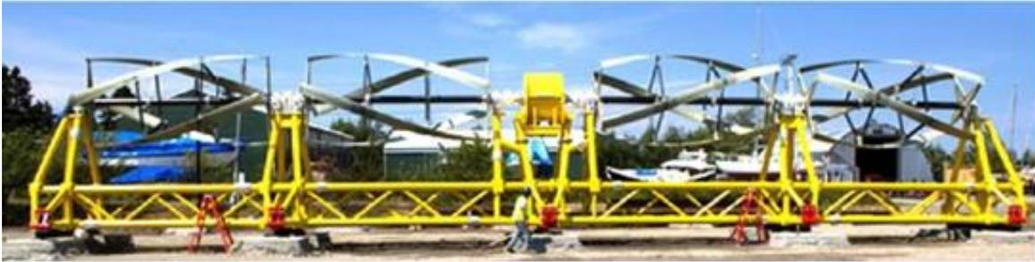
Figura 3.12: Turbina de flujo cruzado de eje horizontal con palas helicoidales, TidGen de ORPC bahía de Fundi, 150 kW. Fuente: <http://kipdf.com>
