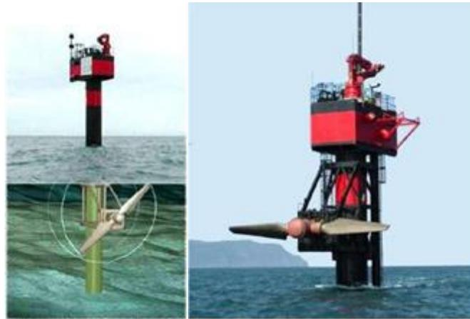
*Modo operacional    Modo mantenimiento turbina*
