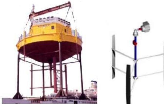
Figura 3.8: Turbina vertical Kobold, 120 kW con 3,5 m/s. Fuente: <http://kipdf.com>
