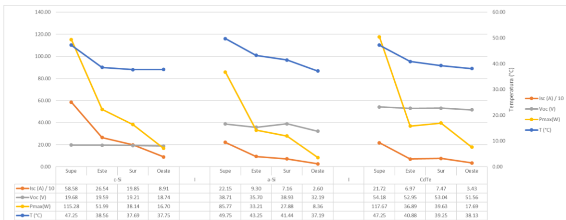
Figura 32. Efecto de la temperatura sobre la Isc, Voc y Pmax en los distintos PV Cubes. Fuente: Propia.
