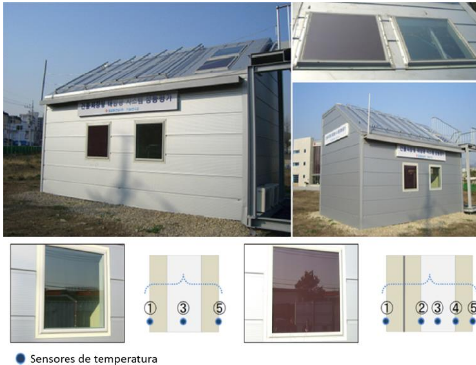
Figura 21. Modelo utilizado para hacer el estudio comparativo. Ventana tradicional (izquierda) y ventana BIPV (derecha) y disposición física de los sensores de temperatura. Fuente: [25]
