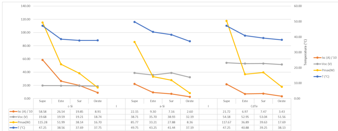
Figura 33. Efecto de la temperatura sobre la I_{mp} , V_{mp} y P_{mp} en los distintos PV Cubes. Fuente: Propia.
