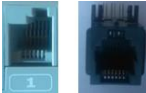
Figura 30: Diferencia entre conectores: conector LEGO (izquierda) conector RJ12 (derecha).
