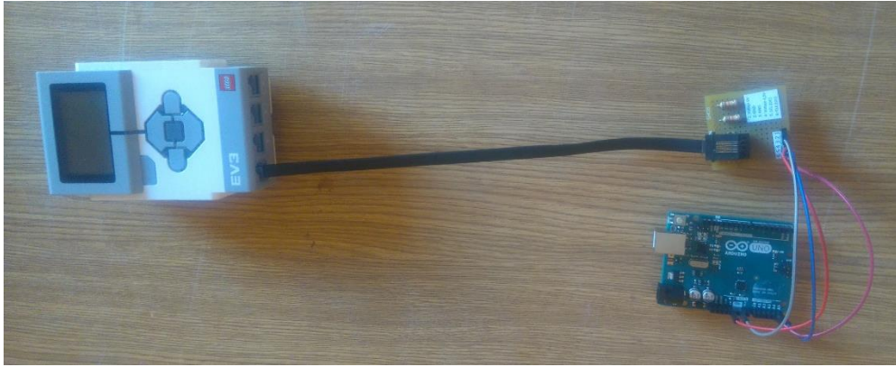
Figura 35: Conexión entre Arduino y LEGO.
