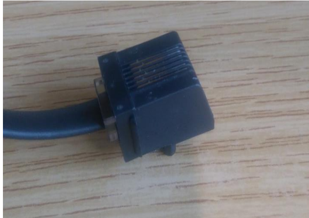
Figura 32: Conexión entre el cable de LEGO y conector RJ12.
