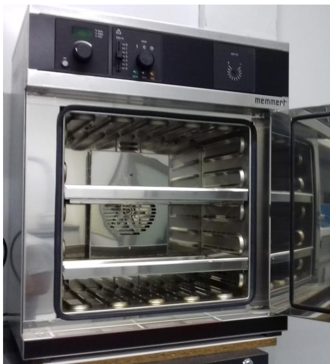
Figura 20. Horno utilizado para realizar el annealing térmico.
