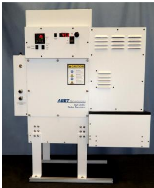
Figura 26. Simulador solar Abet Technologies Sun2000 25 .
