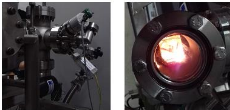
Figura 21. Cámara de evaporación (izquierda) e interior de la cámara donde puede observarse el filamento incandescente (derecha).
