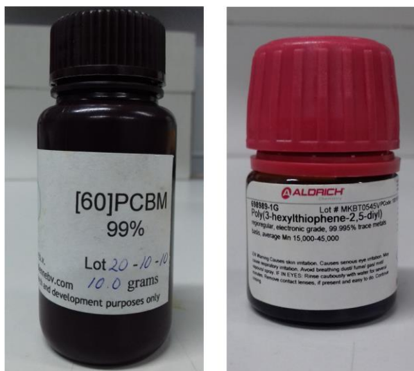
Figura 17. Materiales utilizados para la fabricación de la capa fotoactiva.
