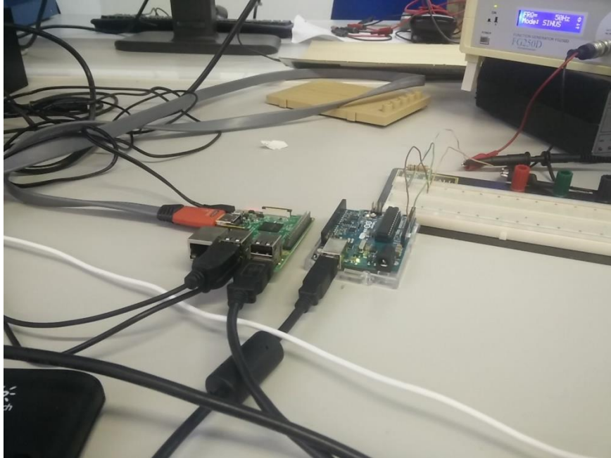
Ilustración 19: Conexión Raspberry - Arduino
