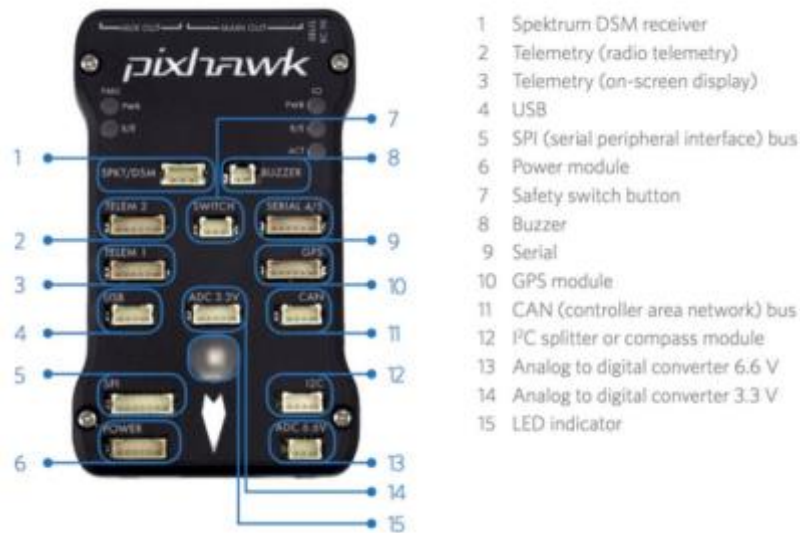
Fig. 5 Conexiones Pixhawk
