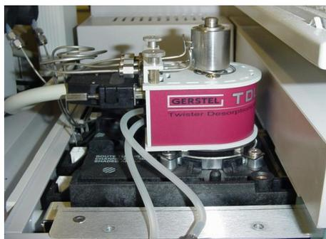
Figura 4.9. Unidad de desorción térmica (TDU).
