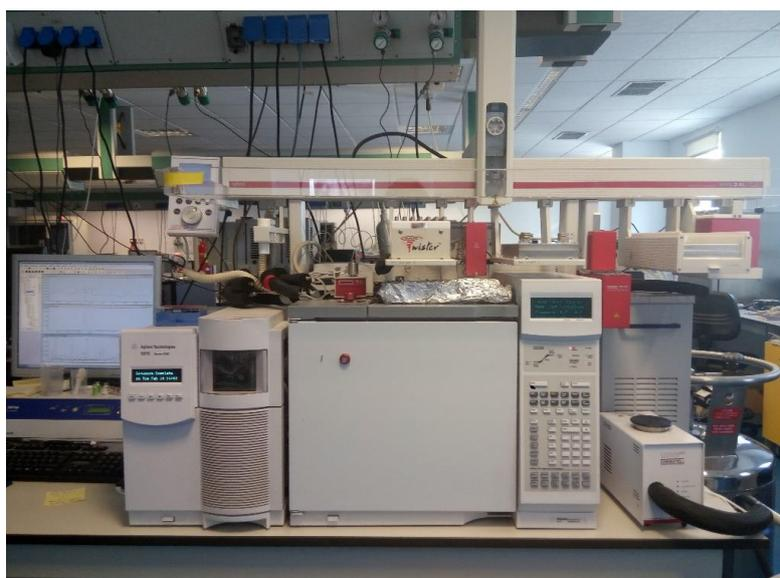
Figura 4.7. Equipo de cromatografía de gases Agilent 6890N acoplado a un detector selectivo de masa 5975N XL (GC-MS)
