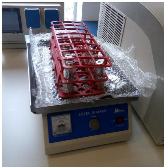
Figura 4.5. Agitador Nahita 685/1 con las muestras de MP en agua dopada y sin dopar.
