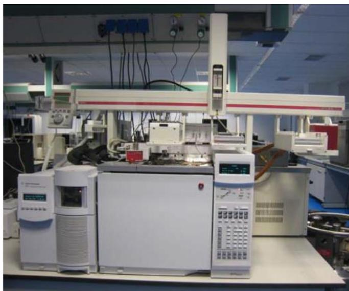
Figura 2.4. Cromatógrafo de gases
