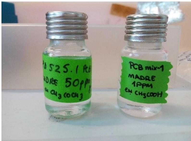
Figura 4.2. Disoluciones madre de 50  $\mu\text{g/ml}$  y 1  $\mu\text{g/ml}$  del PCB-mix 1 disuelto en acetona.
