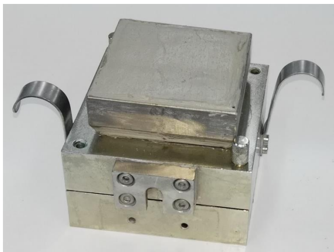
Figura 2.14. Montaje de la probeta.
