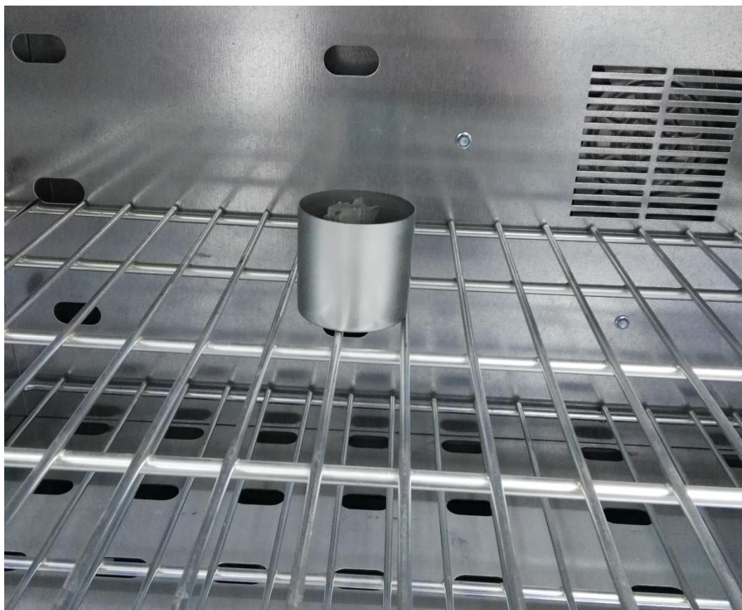
Figura 2.17. Colocación de la muestra de arcilla húmeda en una estufa a 70°C durante 24 horas.
