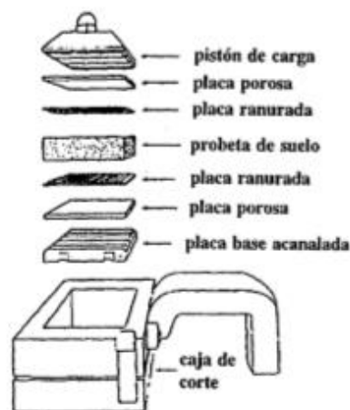
Figura 2.8. Componentes de la caja de corte (Norma UNE 103401).
