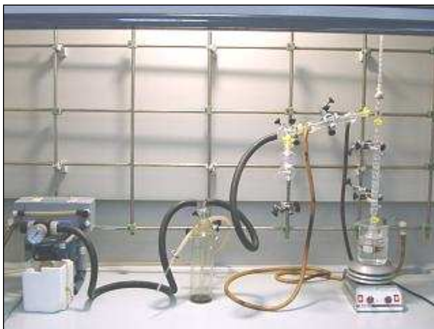
Figura 5.1: Columna de destilación de monómero de polipirrol en un estado de vacío
