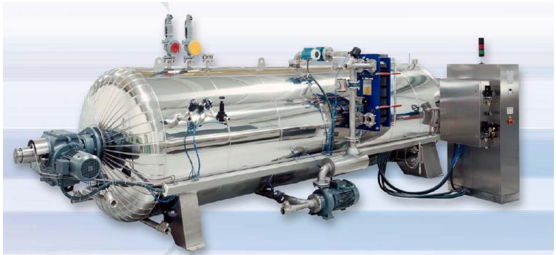
Fig. 4.9: Maquinaria para proceso de esterilización.
