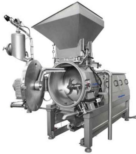
Fig. 4.3: Maquinaria dosificadora de materia prima.
