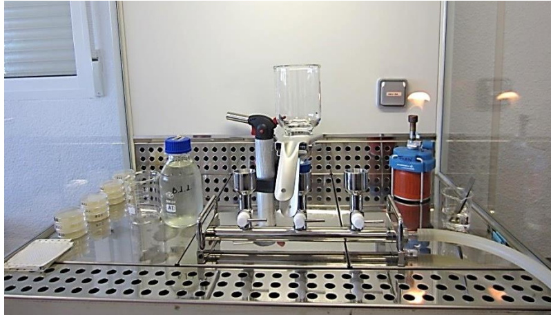
Imagen 18. Sistema de filtración por membranas que se utiliza para la determinación de E. Coli .
