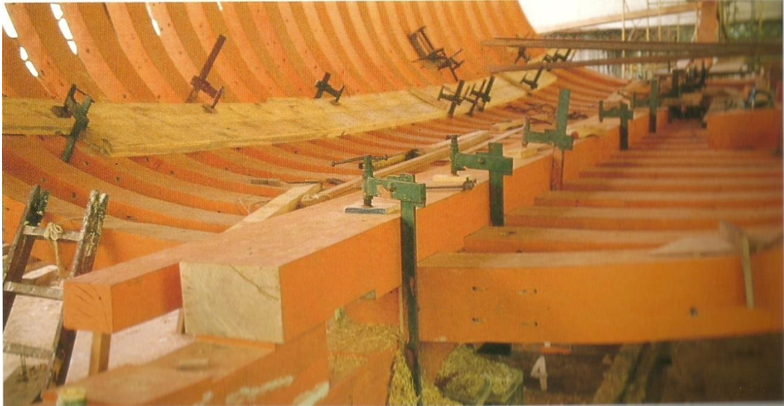
Detalle de la quilla, sobrequilla y cuadernas de la nao Santa María durante la fase de construcción de la enramada para el V Centenario.
