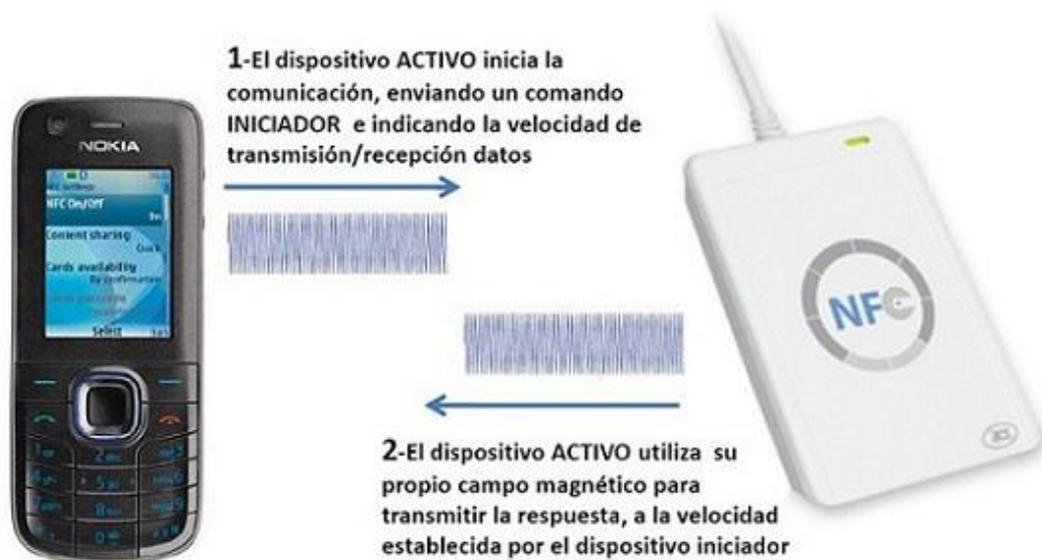
Figura 3-4. Esquema del modo de funcionamiento activo
