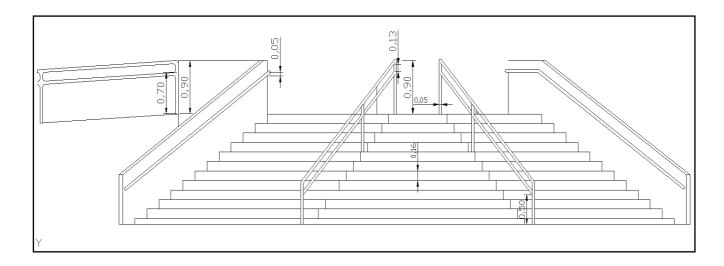
A la izquierda de la imagen se observa los pasamanos dobles de la rampa acotados, el más bajo a 0.7 metros del pavimento de la rampa (según norma entre 0.65 y 0.75 m) y el más alto a 0.9 metros (según norma tiene que estar entre 0.8 y 0.9 metros) ambas alturas cumplen.
