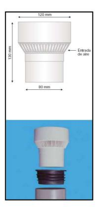
La salida de ventilación deberá de estar convenientemente protegida mediante el sistema de la imagen anterior, y su diseño es tal que la acción del viento favorezca la salida de los gases.
