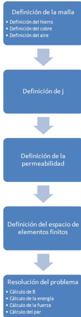
Figura 4.4: Proceso de resolución para el problema del relé
