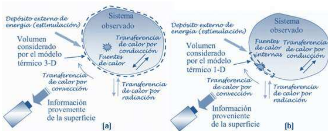
Figura. Contorno de volumen a considerar para el modelado teórico según la naturaleza y la forma del sistema termografiado. Sistema constituido por buenos conductores de calor (a). Sistema constituido por malos conductores de calor (b).
