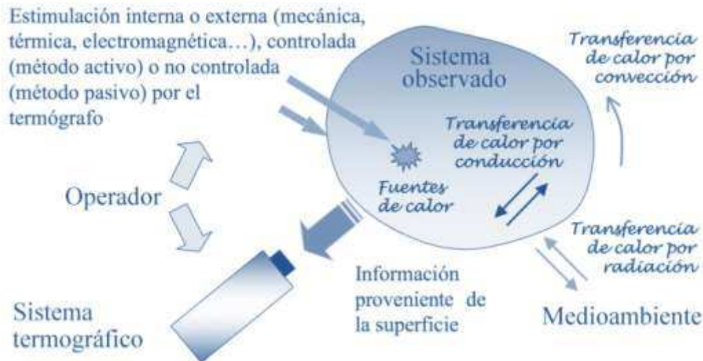
Figura. Fenómenos físicos y actores que intervienen en el ensayo termográfico.
