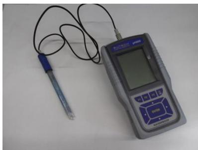
**Imagen 3.21:** Medidor de pH *Eutech*, modelo *CyberScan pH 600*.
