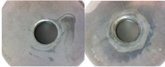
**Imagen 5.7:** Probeta 2 – pH Neutro – Posición superior. (Izquierda: Cara arriba. Derecha: Cara abajo).
