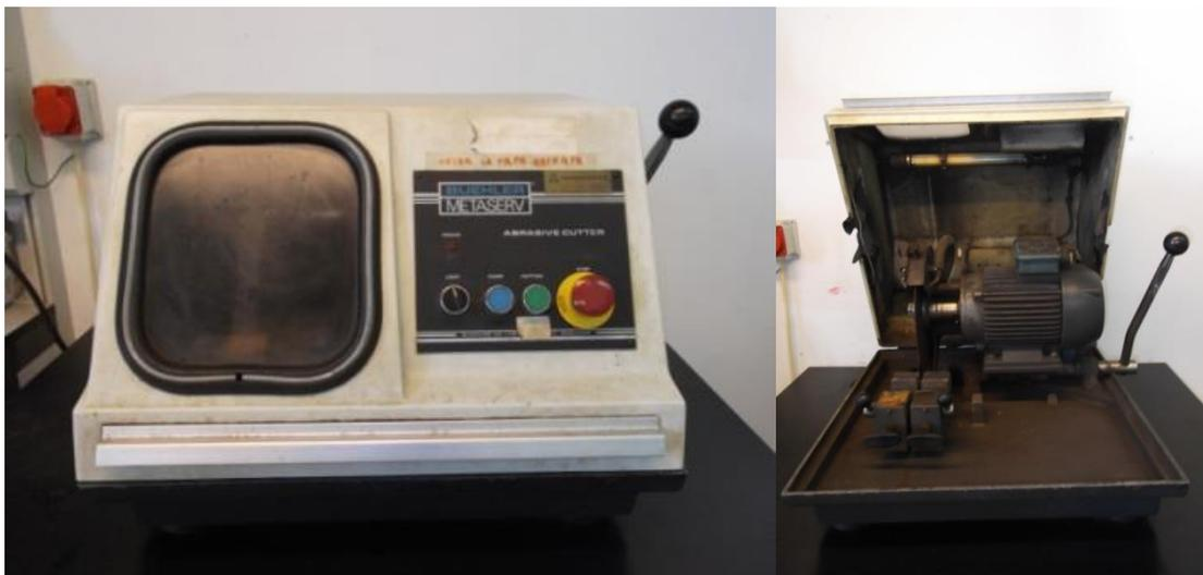
**Imagen 3.9:** Equipo de corte *Buehler*, modelo *Metaserv*.
