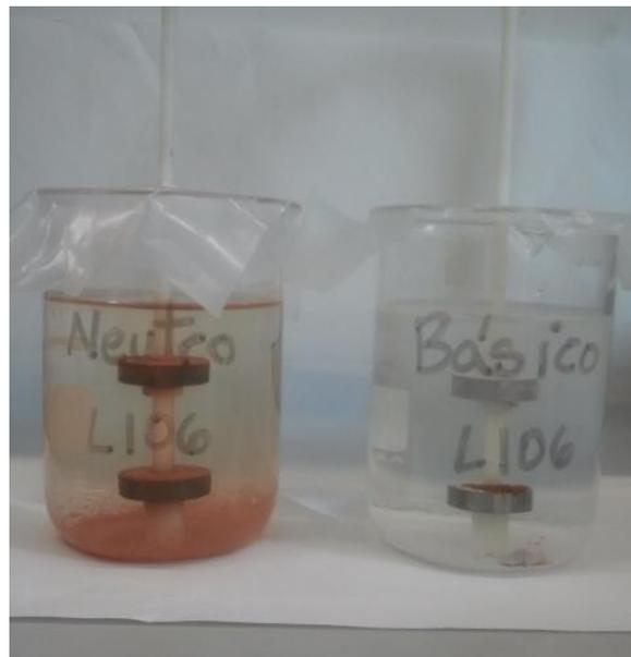
**Imagen 5.43:** Ensayo de inmersión después de 14 días.
