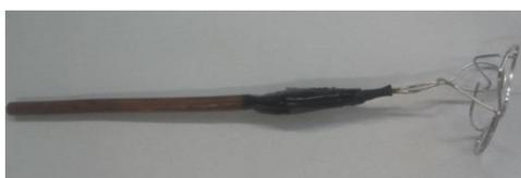
**Imagen 3.20:** Contraelectrodo o electrodo auxiliar de platino.
