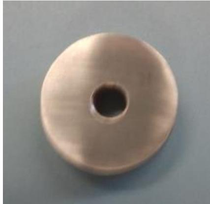
**Imagen 4.1:** Aspecto final de las muestras tras el proceso de desbastado.
