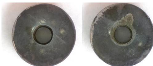
**Imagen 5.45:** Probeta 2.4 – pH Básico – Posición superior. (Izquierda: Cara arriba. Derecha: Cara abajo)
