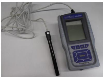
**Imagen 3.22:** Medidor de conductividad Eutech, modelo CyberScan COND serie 600.
