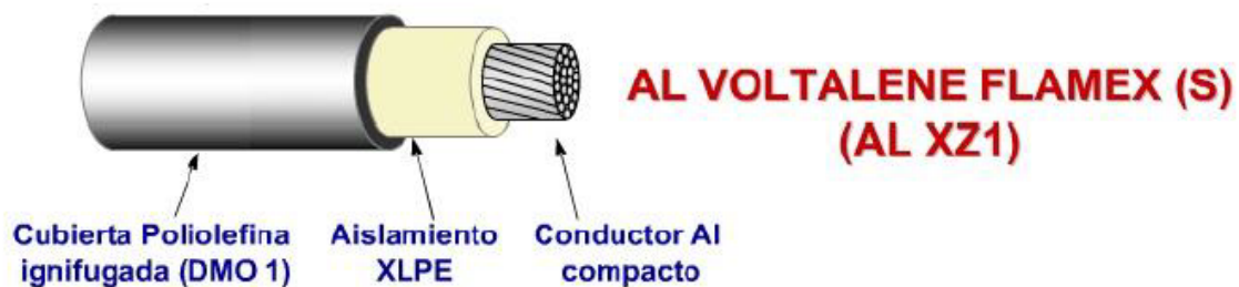
Figura 1: Constitución del cable.
