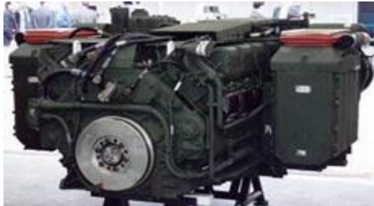
Ilustración 6. Fotografía motor propulsor Naval Motor MTU tipo 12V873Ka501 para carro de combate.
