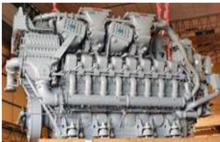
Ilustración 5.Fotografía motor propulsor Naval Motor MTU tipo 1163.
