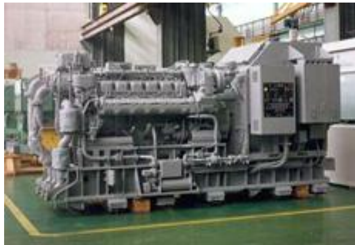
Ilustración 7. Fotografía motor generador Naval Motor MTU tipo 12V396TE54 para Fragatas.
