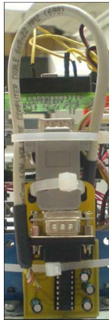
Figura 6.28 Adaptador para max232
