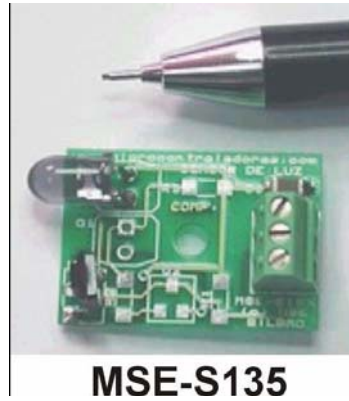
Figura 6.5 Imagen real sensor I.R.
