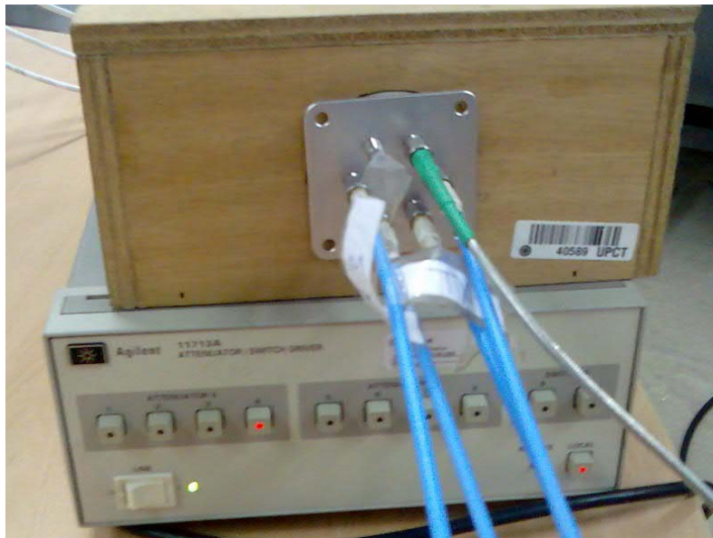
Figura 45: Conmutador y Controlador del sistema de medidas
