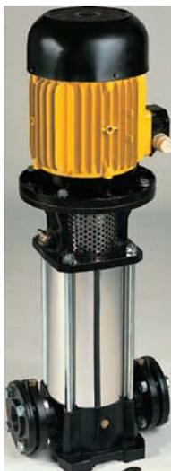
El modelo de bomba a usar podría ser de tipo centrífugas multicelulares verticales IN-LINE VE 121, completamente silenciosas; con brida acoplamiento motor-bomba V1 (ver ficha técnica). Los materiales de los que está compuesta serán de eje bomba y rodetes en acero inoxidable AISI 304, cuerpo de la bomba y la rejilla protegidas en acero inoxidable AISI 304, soportes para la aspiración e impulsión en acero gris de
