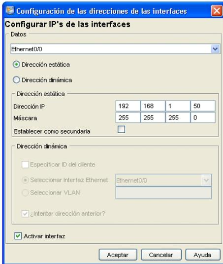
Figura 26 - Interfaz Ethernet con dirección estática
