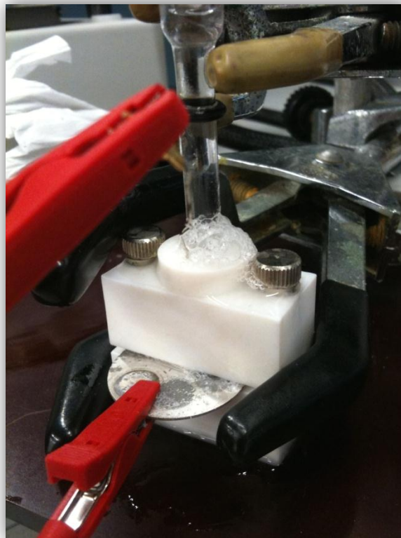
Figura 5.9: Detalle del desprendimiento de burbujas.
