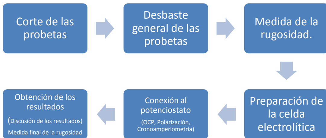
Figura 4.1: Procedimiento experimental seguido en los ensayos de corrosión electroquímica
