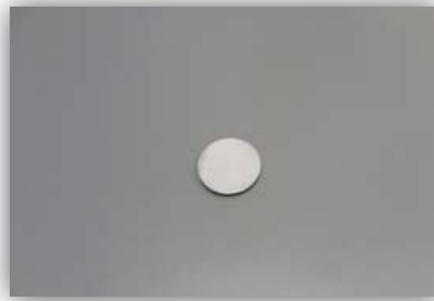
Figura 4.2: Probeta de aleación AZ31B usada en el experimento
