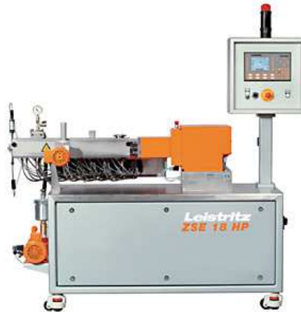
Figura 3.5: Extrusora LEISTRITZ ZSE18 HP.
