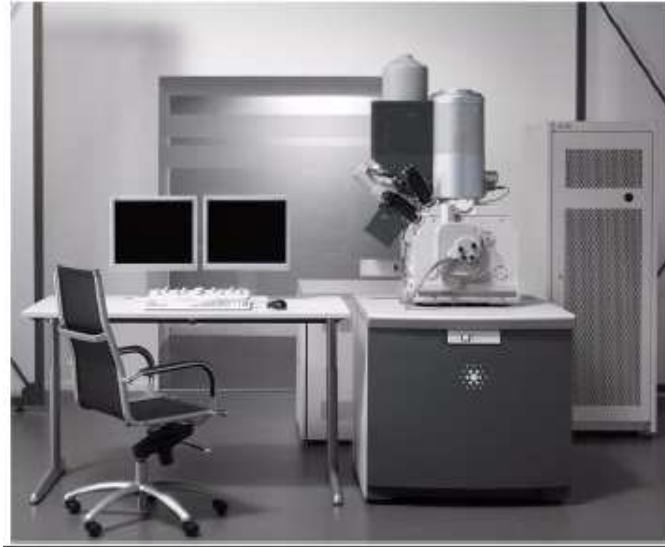
Figura 3.11: Microscopio electrónico de barrido de emisión de campo FEI NOVA 200 NanoLab.
