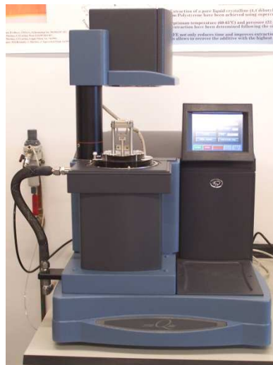
Figura 3.12: Analizador dinamo-mecánico TA Q800.
