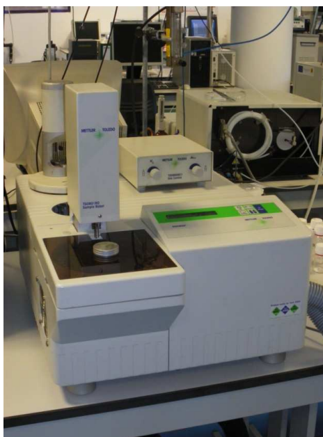
Figura 3.9: Calorímetro 822e de Mettler-Toledo.
