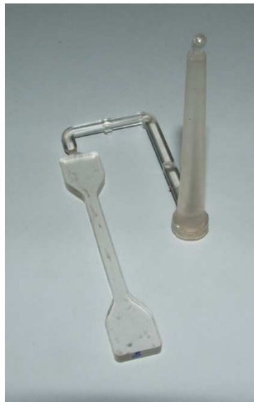
Figura 3.8: Probeta inyectada y canal de alimentación.
