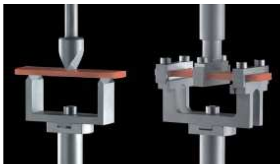
Figura 3.19: Modos de flexión a tres puntos (izquierda) y en viga biempotrada (derecha).
