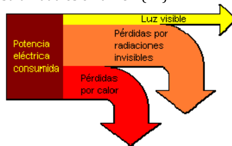
Figura 1. Descomposición de los elementos emitidos por una bombilla
