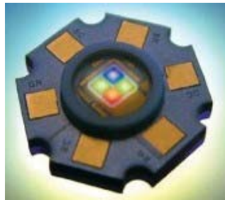
Figura 17. Proporciones de LED's azules, verdes y rojos en un LED tricolor
