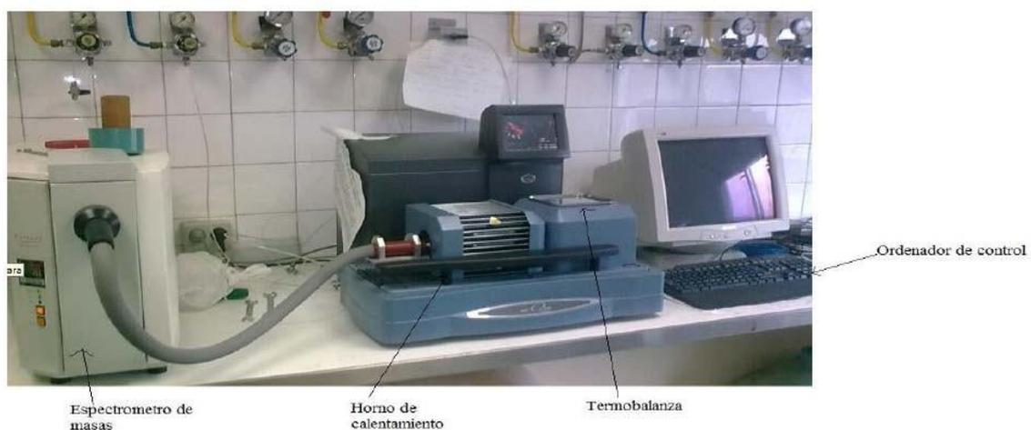
Figura 21. Equipo de termogravimetría [44]
