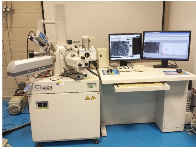
Figura 24. Equipo de SEM Hitachi S-3500N [49]
