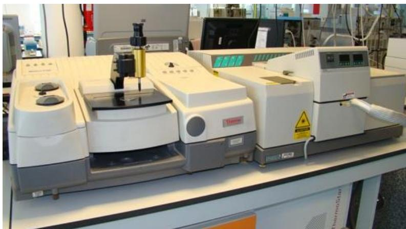
*Figura 27. Equipo de espectroscopía Thermo Nicolet 5700 [51]*
