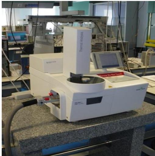
Figura 23. Analizador Termogavimétrico «TGA/DSC 1HT» de Mettler-Toledo [47]
