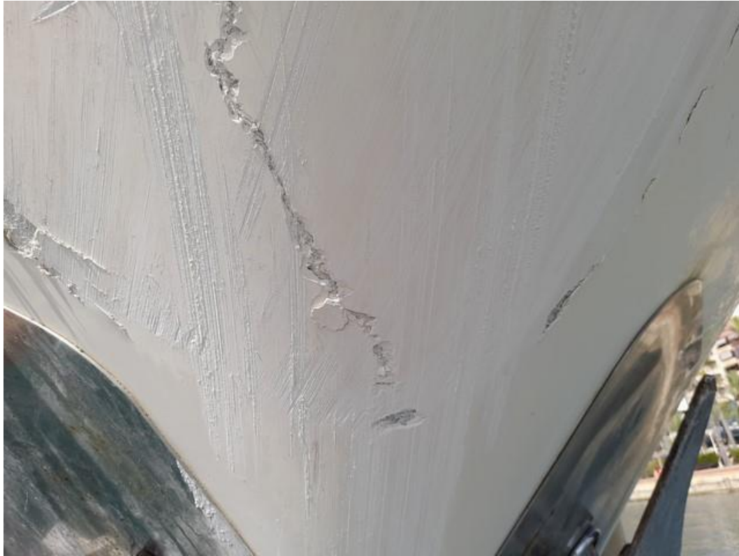
Ilustración 8. Ejemplo impacto en roda de embarcación de recreo afectando estructura y fibra.
