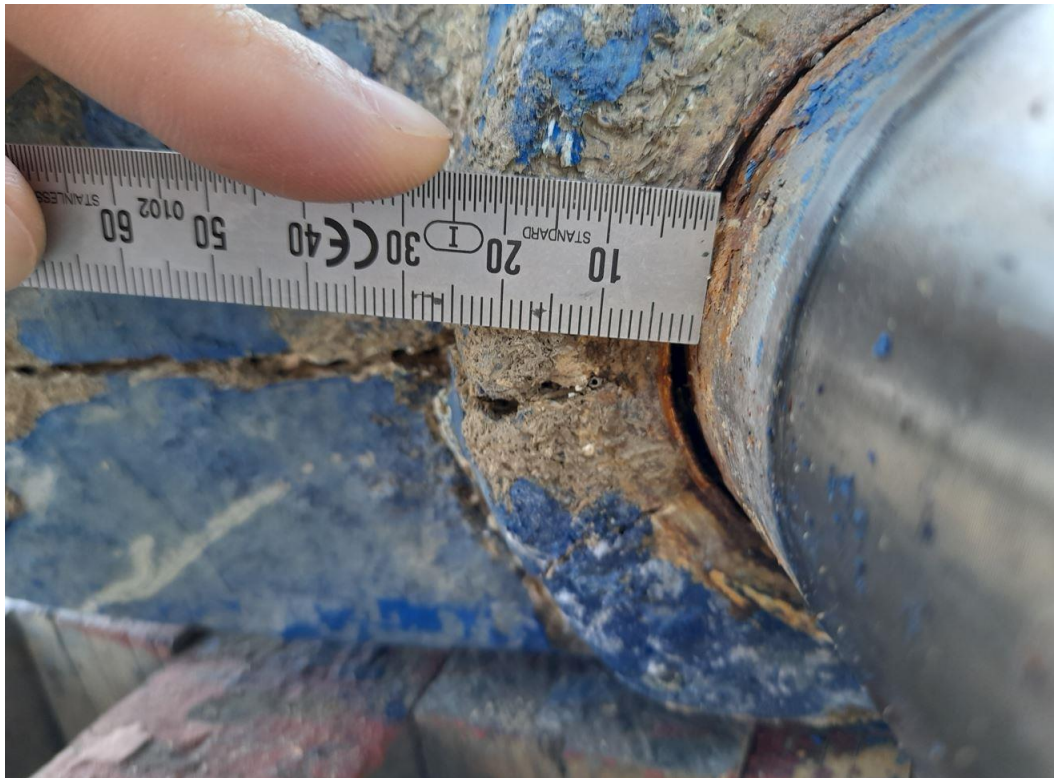
Ilustración 19. Ejemplo desalineación mecha del timón.
