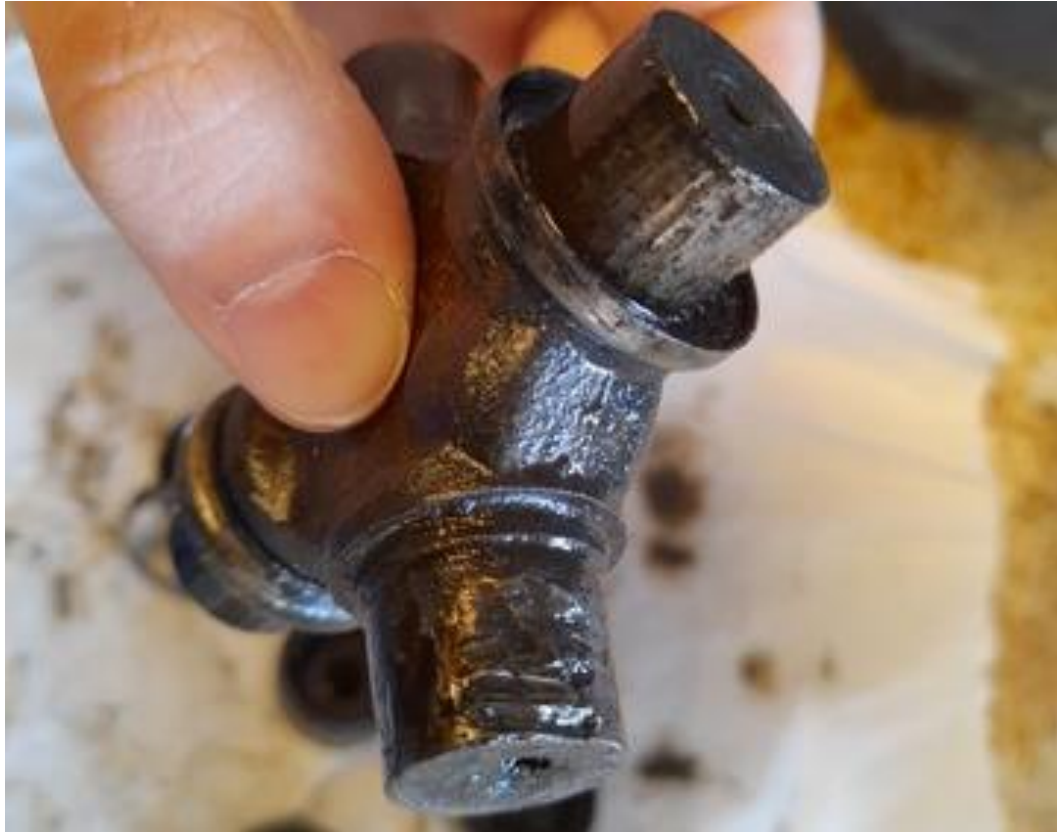
Ilustración 29. Ejemplo daños en cruceta transmisión del engranaje cardan de la cola de propulsión.
