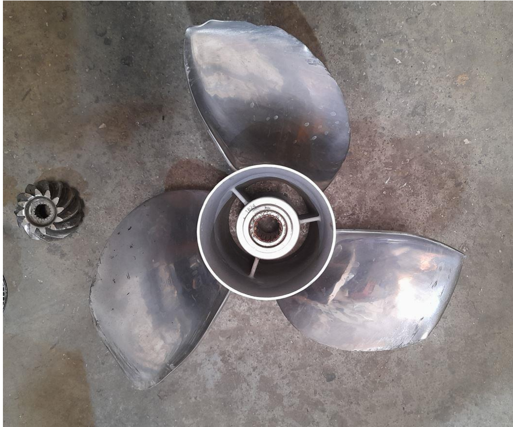
Ilustración 21. Ejemplo hélice dañada por impacto en rotación.
