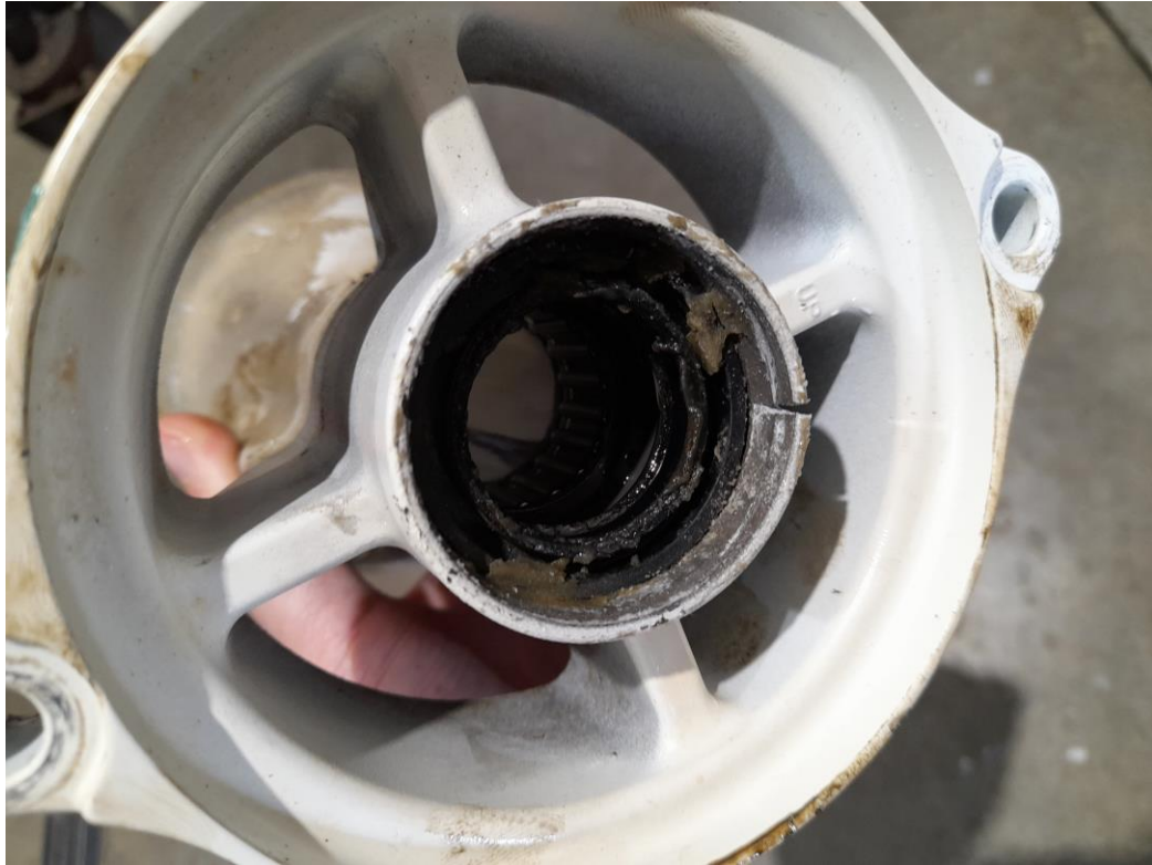
Ilustración 30. Ejemplo rotura diábolo cola de propulsión.
