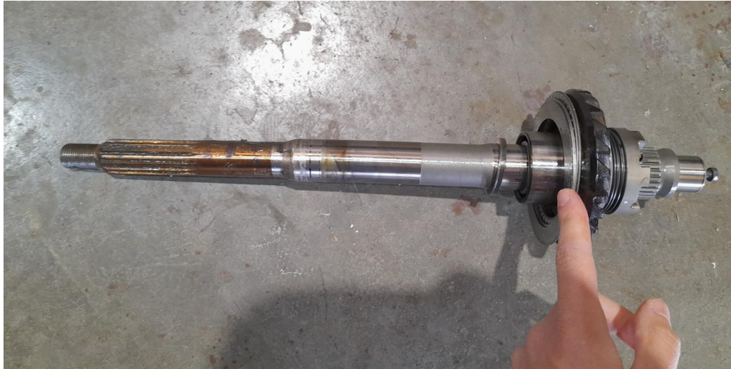
Ilustración 22. Ejemplo desalineación eje motor fueraborda.
