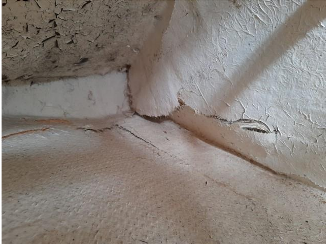
Ilustración 9. Ejemplo impacto roda afectando estructura embarcación recreo.
