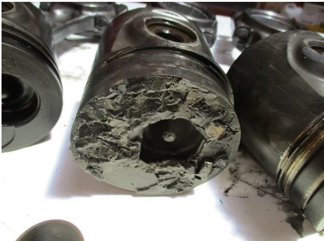
Ilustración 35. Ejemplo cabeza pistón deteriorada.
