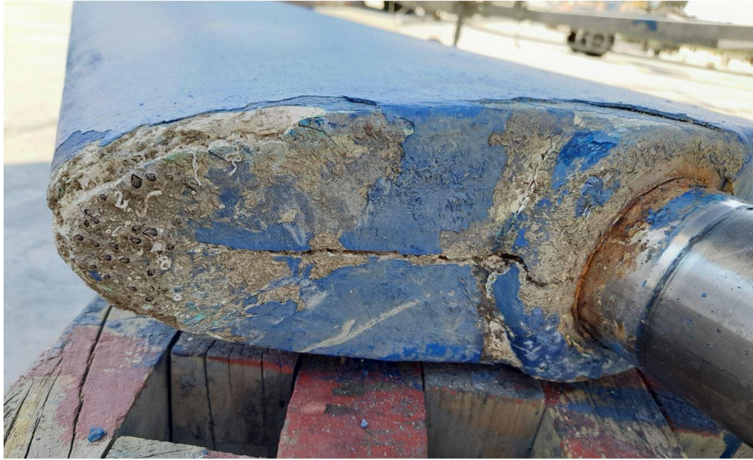
Ilustración 18. Ejemplo rotura pala de timón.
