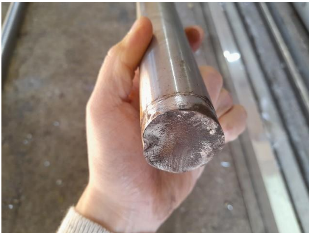
Ilustración 23. Ejemplo rotura eje por fatiga.
