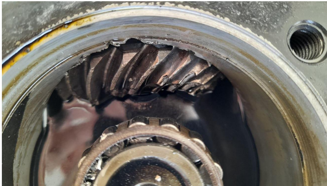
Ilustración 28. Ejemplo engranaje transmisión de la cola y carcasa superior dañados
