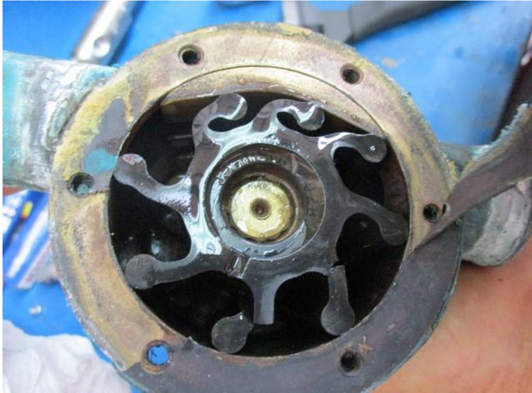
Ilustración 32. Ejemplo rotura impeller bomba refrigeración motor.
