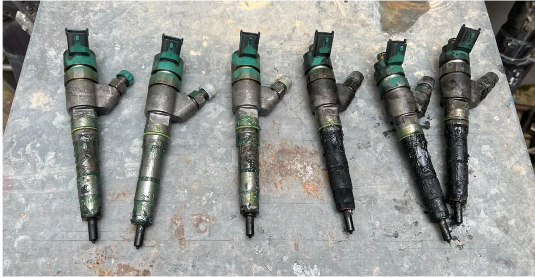
Ilustración 34. Ejemplo inyectores quemados mala combustión.
