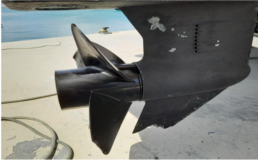
Ilustración 27. Ejemplo rotura aletín cola por impacto.
