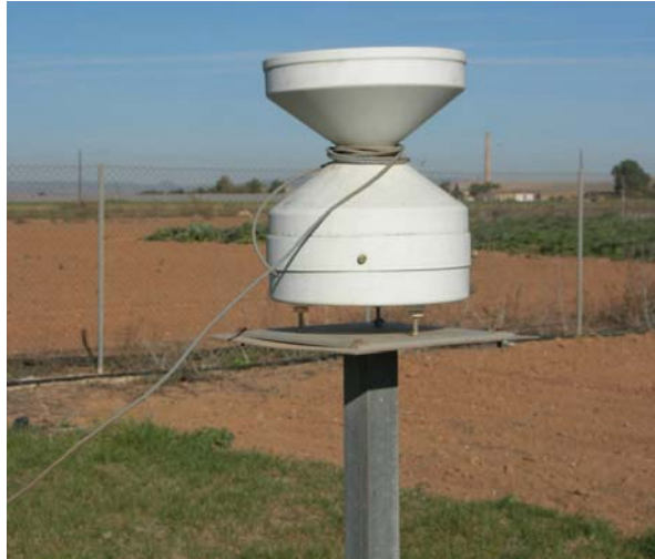
Figura 3.5. Pluviómetro con sensor FSS500 colocado a 1.5 m del suelo.
