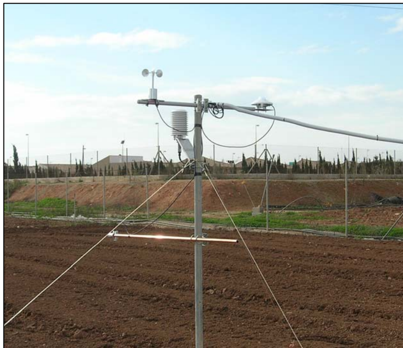
Figura 3.1. Estación climática automática de la ESEA ‘Tomás Ferro’ y disposición de los distintos sensores.
