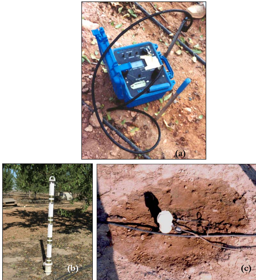
Figura 3.9. a) Equipo TDR y sondas instaladas en suelo, b) sensores FDR sobre guía c) sensores FDR instalados en campo.
