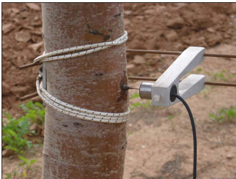
Figura 3.14. Sensor LVDT y portasensor en tronco.
