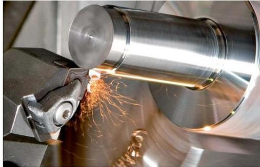
*Figura 26. Ejemplo real de cilindrado*
